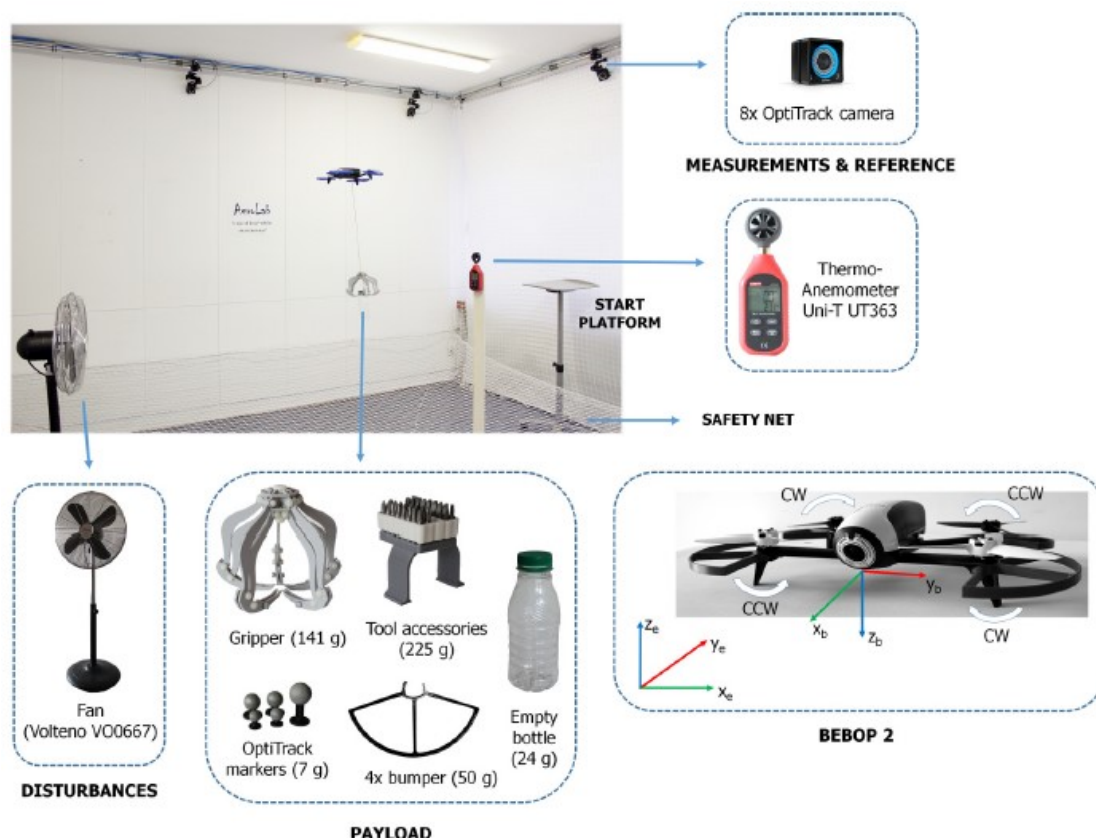
Quadrotor Bebop 2 (i jego układ współrzędnych) podczas jednego z początkowych eksperymentów z przewozem ładunków w laboratorium AeroLab Politechniki Poznańskiej.
